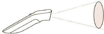
放射体温計は、測定対象との距離で測定面積が異なり、測定面積の平均温度を表示します。CISEは、測定距離と測定面積との関係は以下のようになります。
